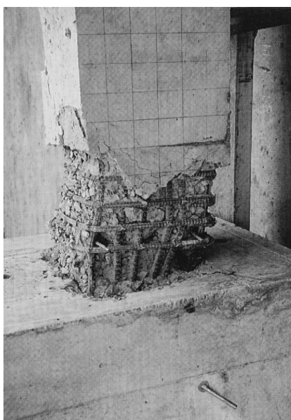
写真-2.2 曲げ破壊
